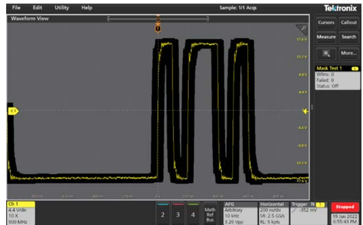
Teste de máscara de limite com base no sinal de referência dourado
