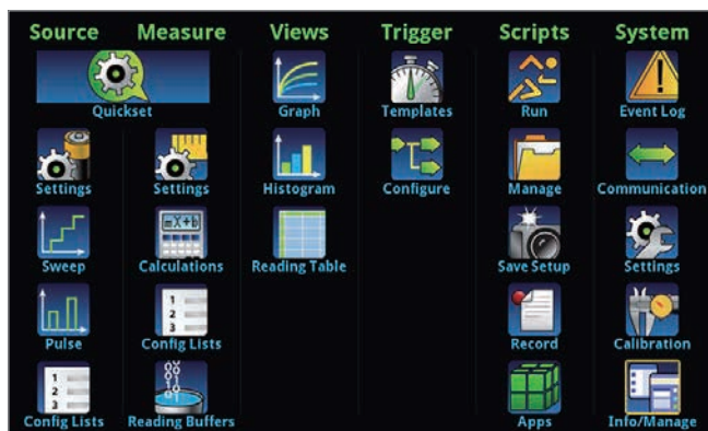
グラフィカル・ソースメータのアイコンベースのメニュー構造により、初心者でもすばやく確実に設定できる
