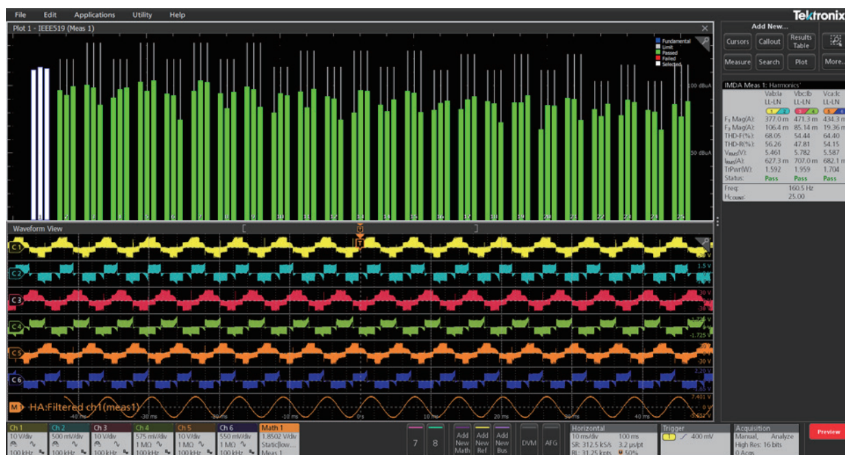
図24. 高調波はモータ駆動回路の入出力の両側が測定できる。この例は、駆動回路の三相出力の高調波を示している
